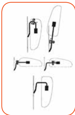
تصویر ۴ - تغییر شکل پایه فلزی به کمک پلایر
